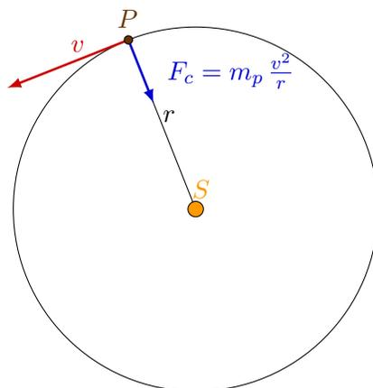
**Figura 7:** Il pianeta  $P$  descrive, nel suo moto di rivoluzione attorno al sole, un'orbita circolare e la sua velocità è costante in modulo.
