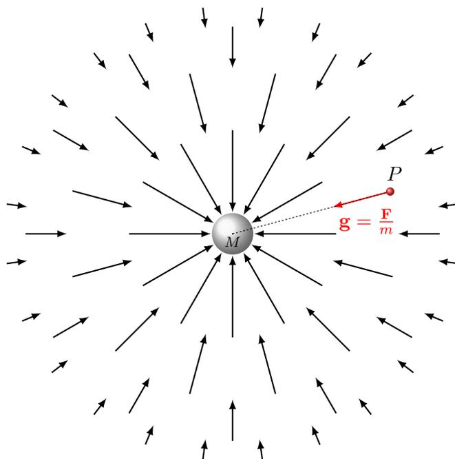
**Figura 8:** Campo gravitazionale generato dalla massa  $M$ . Nel punto  $P$  è stata posta la carica di prova  $m \ll M$
