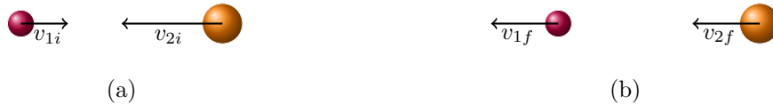
Figura 1: Esempio di urto elastico: (a) due sfere prima dell'urto; (b) le sfere dopo l'urto
