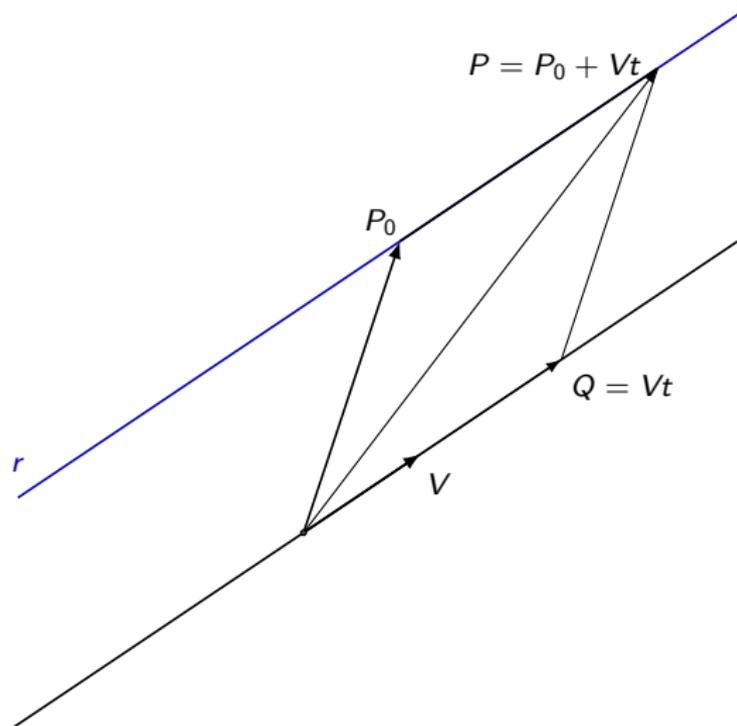
Qualsiasi punto  $P$  della retta  $r$  si ottiene sommando il vettore  $P_0$  con il vettore  $Q = Vt$  ( $t \in \mathbb{R}$ ).
