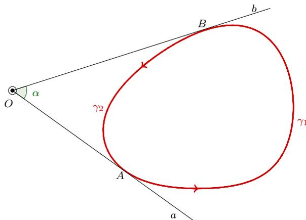
**Figura 4:** Circuitazione di  $\mathbf{B}$  lungo una linea chiusa *non* concatenata con il filo.
