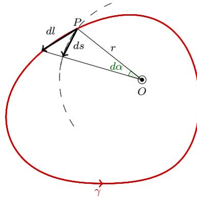
**Figura 3:** Circuitazione di  $\mathbf{B}$  lungo una linea chiusa concatenata con un filo rettilineo perpendicolare al foglio. La corrente è uscente dal foglio.
