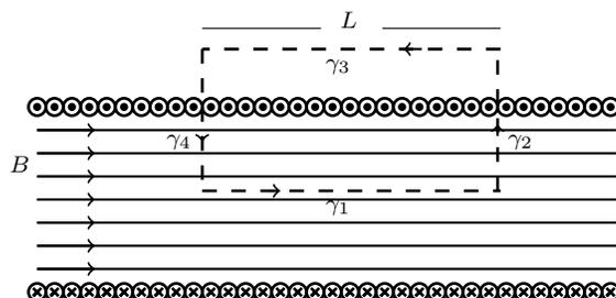
**Figura 5:** Il campo magnetico all'interno del solenoide è uniforme e ha direzione parallela a quella del suo asse, mentre nei punti esterni è praticamente nullo.
