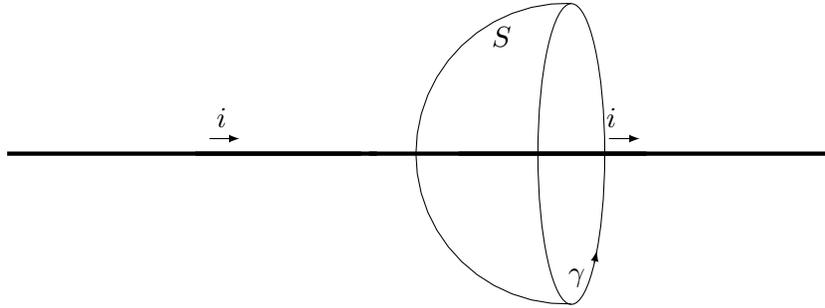
**Figura 2:** La superficie  $S$  avente per bordo  $\gamma$  interseca il filo conduttore. Questo fatto succede per ogni superficie di bordo  $\gamma$ . Segue che la corrente è concatenata con il filo.
