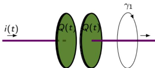
Secondo la legge di Ampere  $\int_{\gamma_1} \mathbf{B} \cdot d\mathbf{l} = 0$  perché  $\gamma_1$  non è concatenata con il circuito.
