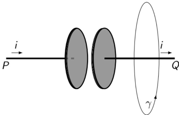
**Figure:** Circuito formato da un condensatore e da un generatore di corrente.
