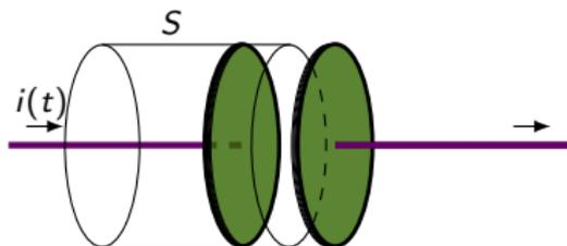
Fra le armature del condensatore si crea un campo elettrico  $\mathbf{E}$ . Il flusso  $\Phi(\mathbf{E})$  uscente dalla superficie (gaussiana)  $S$  rappresentata in figura è, per il teorema di Gauss:
