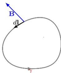
**Figura 1:** Circuitazione di  $\mathbf{B}$  lungo la linea chiusa  $\gamma$
