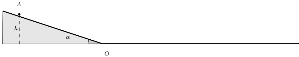
Figura 3: Il corpo, inizialmente in A , scende lungo il piano inclinato e prosegue il suo moto lungo il piano orizzontale.
